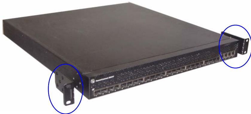
図1 ブラケットの取り付け
